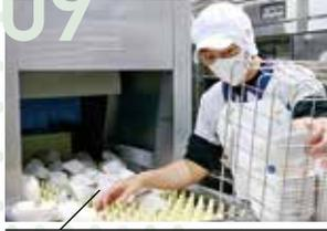
高機能の食洗器で、多い時には1日5000個以上の食器や箸などを洗います。モービルシンク(移動式水槽)を多く設置し、洗浄回数も1日3回から2回に減らして、人手の多い日勤帯に洗浄。遅出の人が早く退勤できるよう働き方改革をはかりました。
